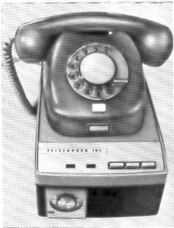
Obr. 96. Přístroj pro automatické odpovídání na telefonická volání TELEFUNKEN Anrufbeantworter T 104
