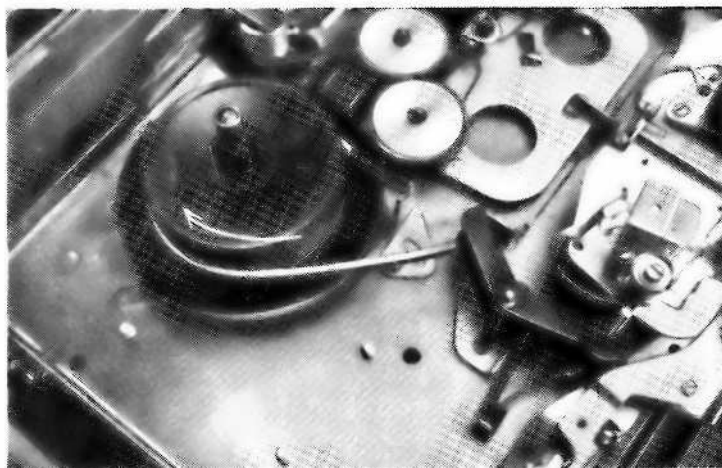
Obr. 38. Praktické provedení brzdy, zajišťující rovnoměrný tah pásku z odvíjecí cívky
