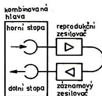
Obr. 88. Princip přepisu záznamu jedné stopy na druhou stopu v případě kombinované hlavy
