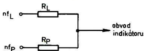
Obr. 66. Základní princip zapojení jednoho indikátoru ke dvěma kanálům stereofonního zesilovače
